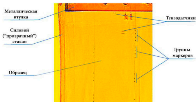
Рис. 6. Рентгенограмма, установленного в стенде образца с наклеенными маркерами
