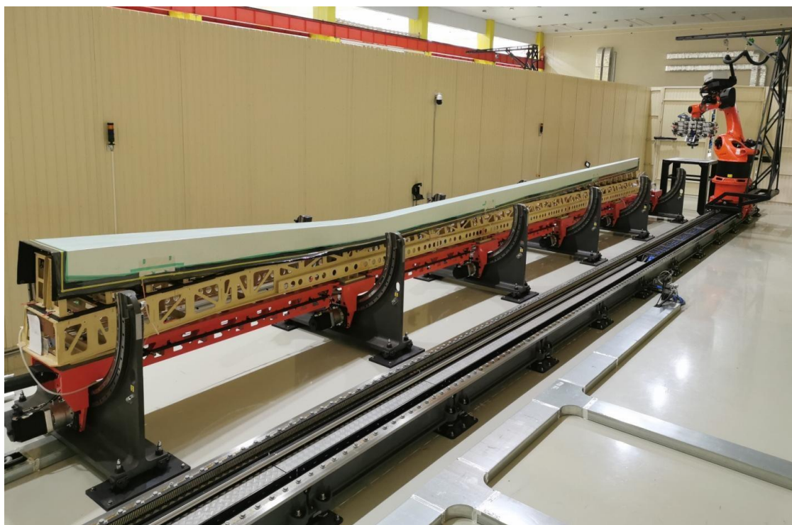
Рисунок 4 – Фотография разработанного роботизированного комплекса автоматизированной выкладки силовых конструкций крыла самолета МС-21 с универсальным позиционирующим устройством
