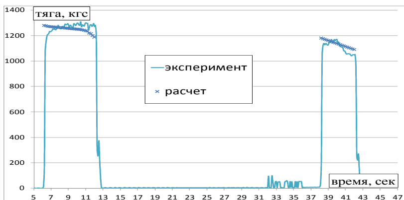
Рис. 12. Зависимость тяги от времени во втором испытании.
