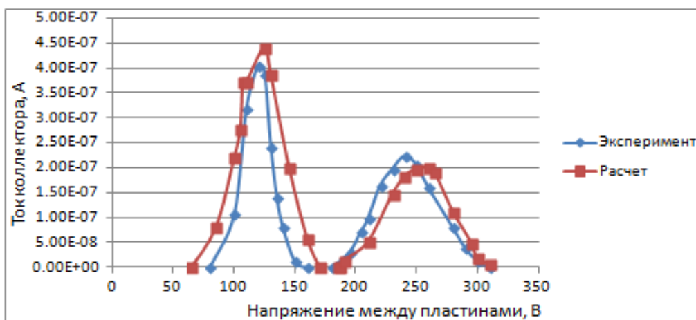
Рисунок 12 — Экспериментальная и расчётная зависимости тока коллектора от отклоняющего напряжения
