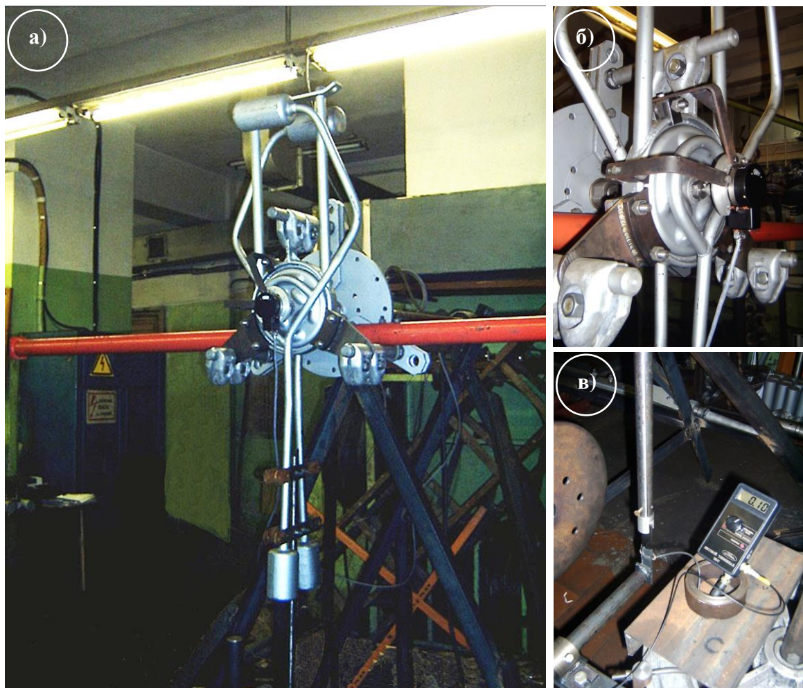
Рис. 2.6. Экспериментальная установка: а) общий вид; б) демпферный узел с аналоговым угломером; в) штанга с тензометрическим динамометром
