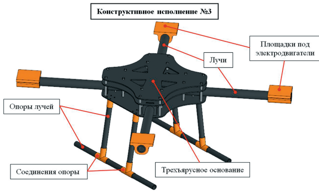
Рис. 3. Конструктивное исполнение № 3 рамы БПЛА
