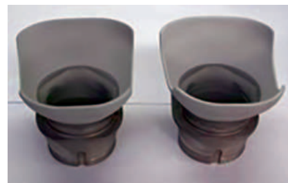
Рис. 15. Горелка с нанесенным ТЗП
