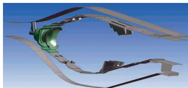
Рис. 8. Камера сгорания с втулками на жаровой трубе
