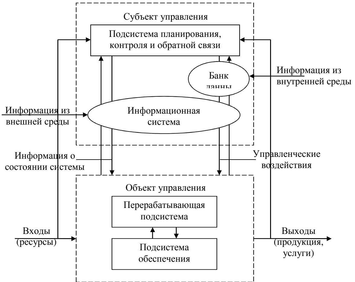
Рисунок 6. Кибернетическая модель процесса производства
