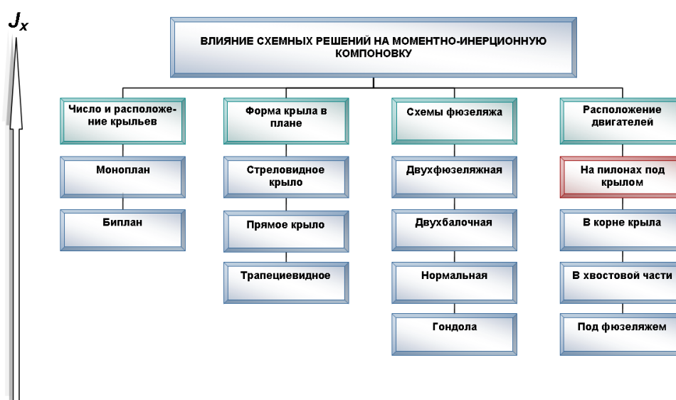
Рис. 3. Влияние схемных решений на моментно-инерционную компоновку относительно оси OX
