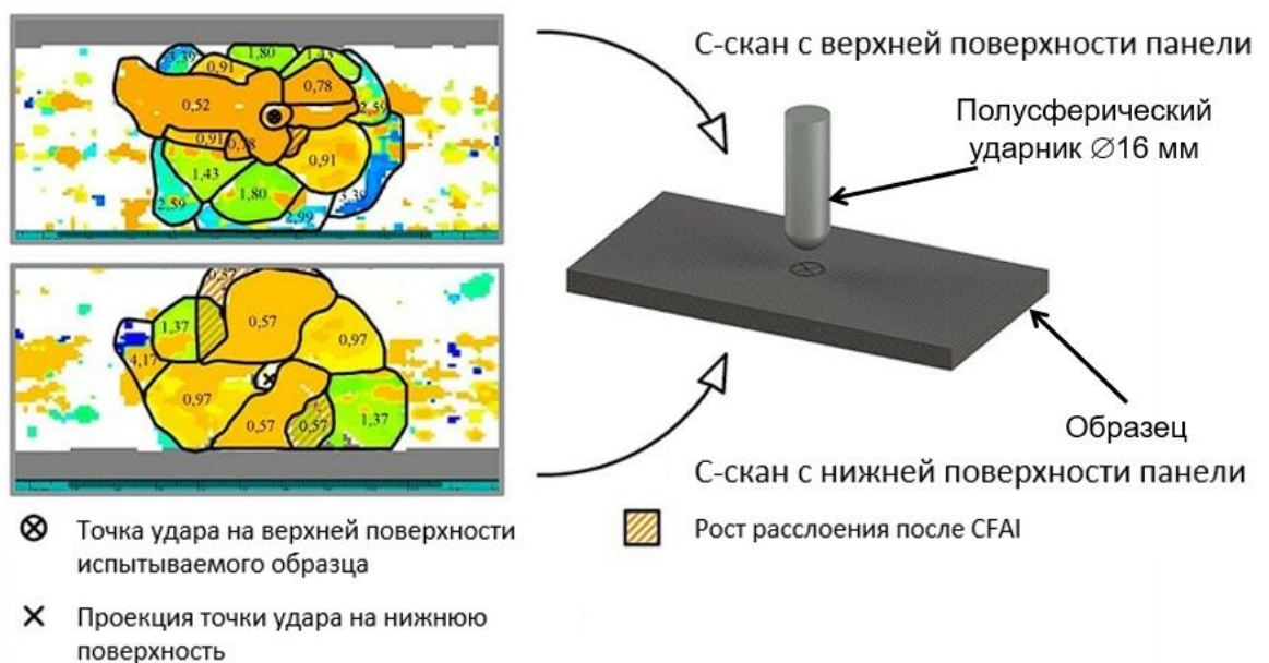
Рисунок 7 - Данные ультразвуковой диагностики поврежденного образца 5040.UMT.241.01 после циклов нагрузки
