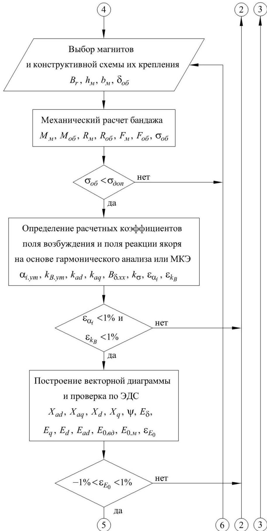
Рисунок 2.11 - Блок-схема расчета генератора с постоянными магнитами.
