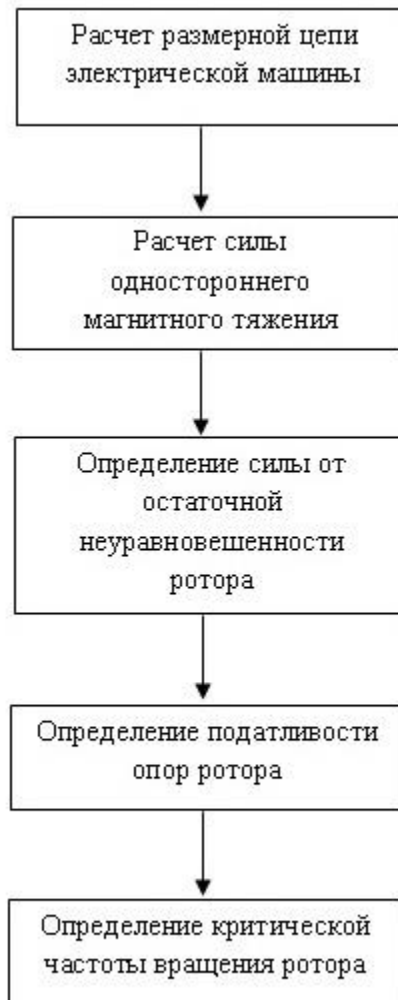
Рисунок 3.1 - Алгоритм расчета критических частот вращения роторов электрических машин с постоянными магнитами.
