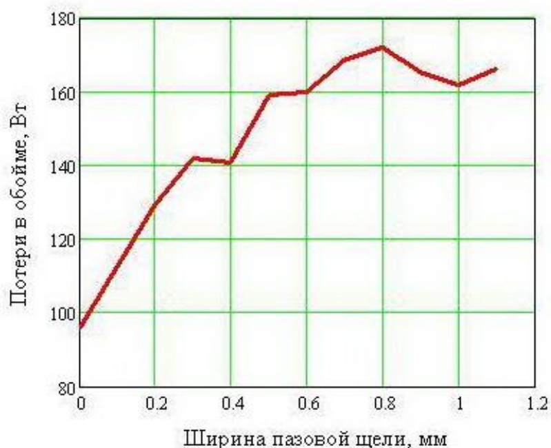
Рисунок 4.6 - График зависимости потерь в обойме от ширины пазовой щели.
