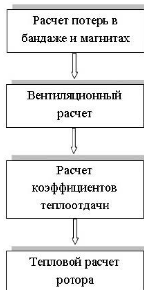
Рисунок 4.5 – Алгоритм теплового расчета ротора с постоянными магнитами.
