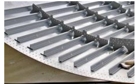
Рисунок 22 – Соединения методом ВСТП конструкций фюзеляжа самолета (сплав 1163 РДТВ)
