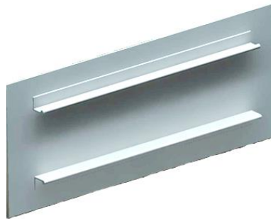
Рисунок 22 – Соединения методом ВСТП конструкций фюзеляжа самолета (сплав 1163 РДТВ)
