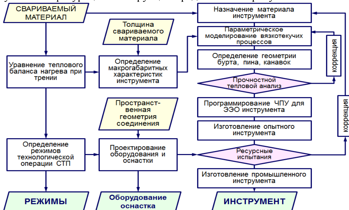
Рисунок 5 – Методика отработки технологического обеспечения сварки трением перемешиванием
