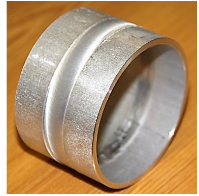
Рисунок 21 – Технологическая схема и сваренные образцы кольцевых конструкций
