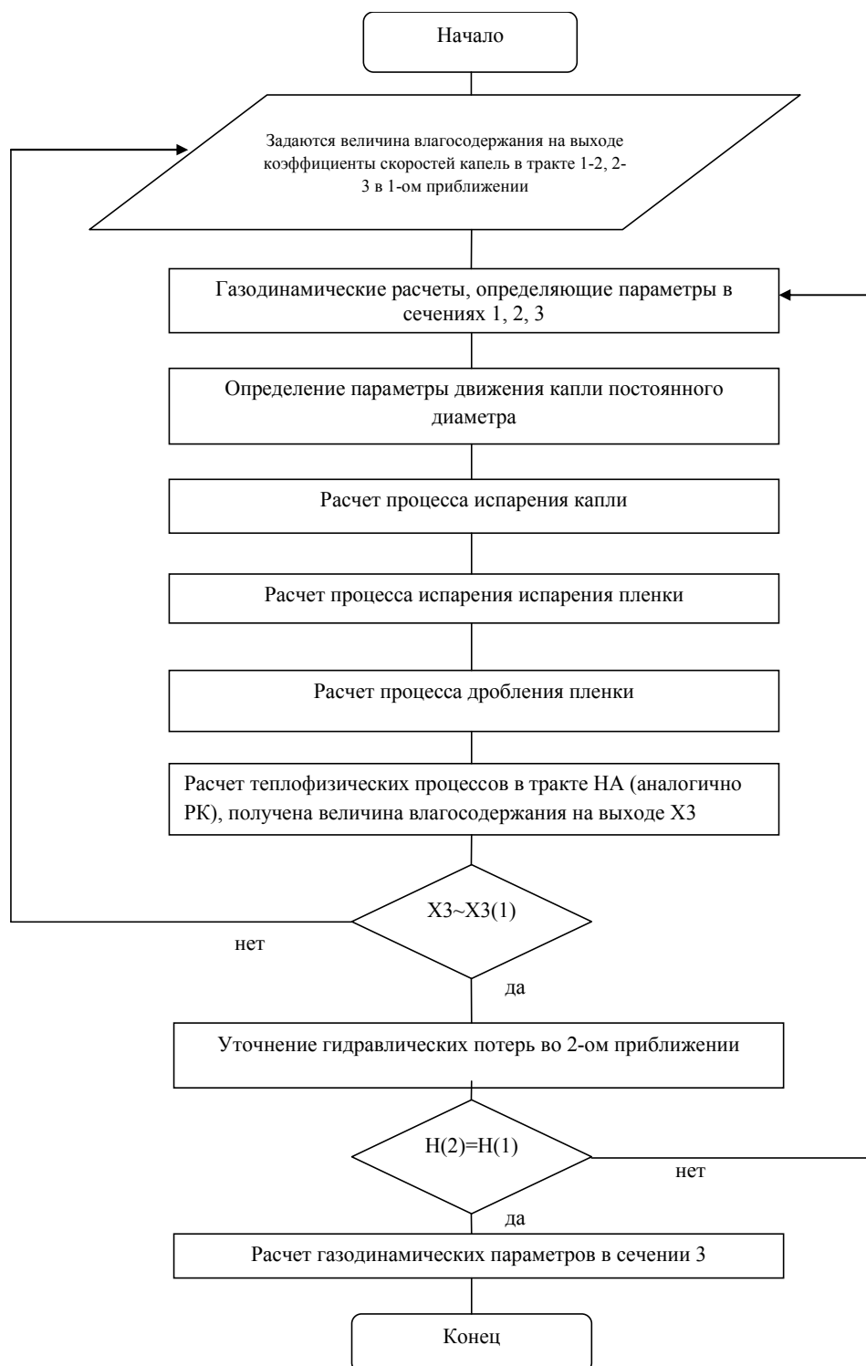
Рис.2. Блок-схема алгоритма расчета процесса «влажного» сжатия
