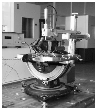
Рис. 28 Общий вид системы для измерения азимутальной равномерности магнитной индукции
