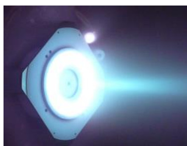
Рис.69 Внешний вид двигателя при работе на К-К в положении 1 (режим 300 В, 4,5 А)
