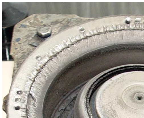
Рис. 92 Общий вид двигателя PPS-1350 после наработки 9000 часов
