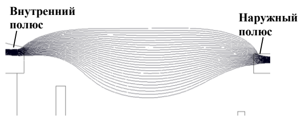
Рис. 38 Магнитная линза для МС с насыщением внутреннего магнитного экрана
