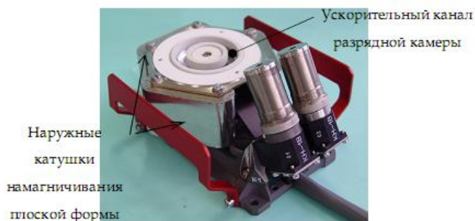
в) Прототип Плас-40 с МС, содержащей три наружные катушки плоской формы
