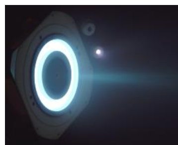
Рис. 70 Внешний вид двигателя при работе на К-К в положении 2 (режим 300 В, 4,5 А)
