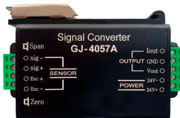
Рисунок 3.11 Усилитель сигнала для динамометра
