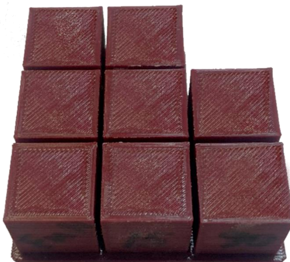
Рисунок.5.1 Серия образцов, изготовленная методом послойного наплавления
