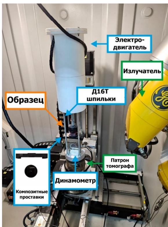
Рисунок 3.20 Оснастка внутри компьютерного томографа
