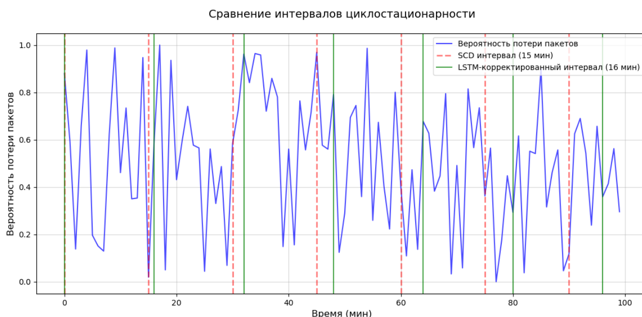
Рисунок 6 – График вероятности потери пакетов для представленного примера с уточненными интервалами циклостационарности
