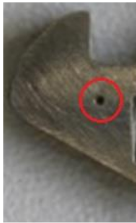
Рисунок 4.16 – Раковина в массивном узле 1
