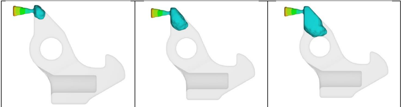
Рисунок 4.7 – Подвод шликера к массивной части узла 3
