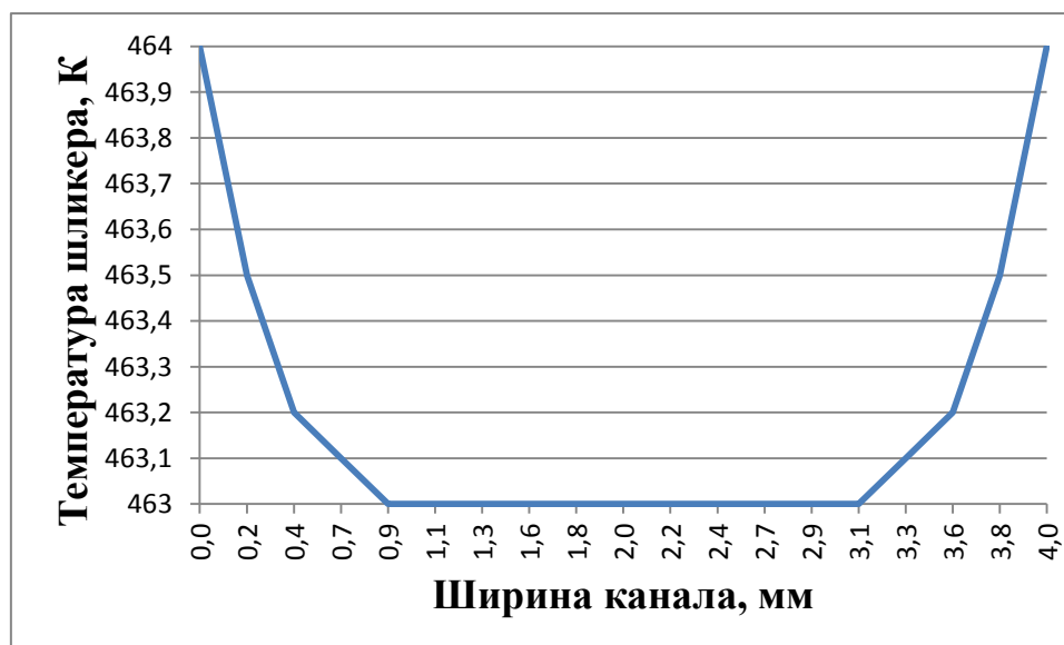
Рисунок 3.10 – Изменение температуры шликера в канале за счет трения
