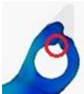
Рисунок 4.19 – Захват воздуха в массивном узле 3
