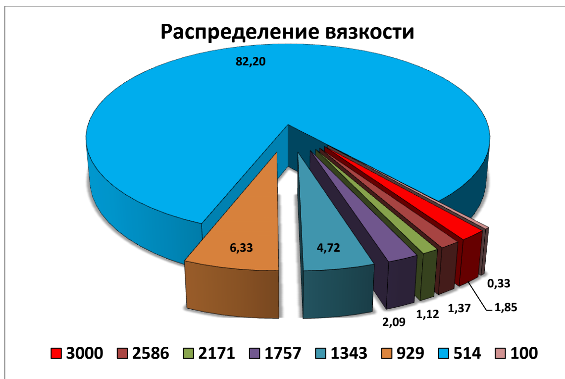
Рисунок 3.21 – Диаграмма распределения вязкости в цилиндрическом канале диаметром 2мм и перегибами 90°
