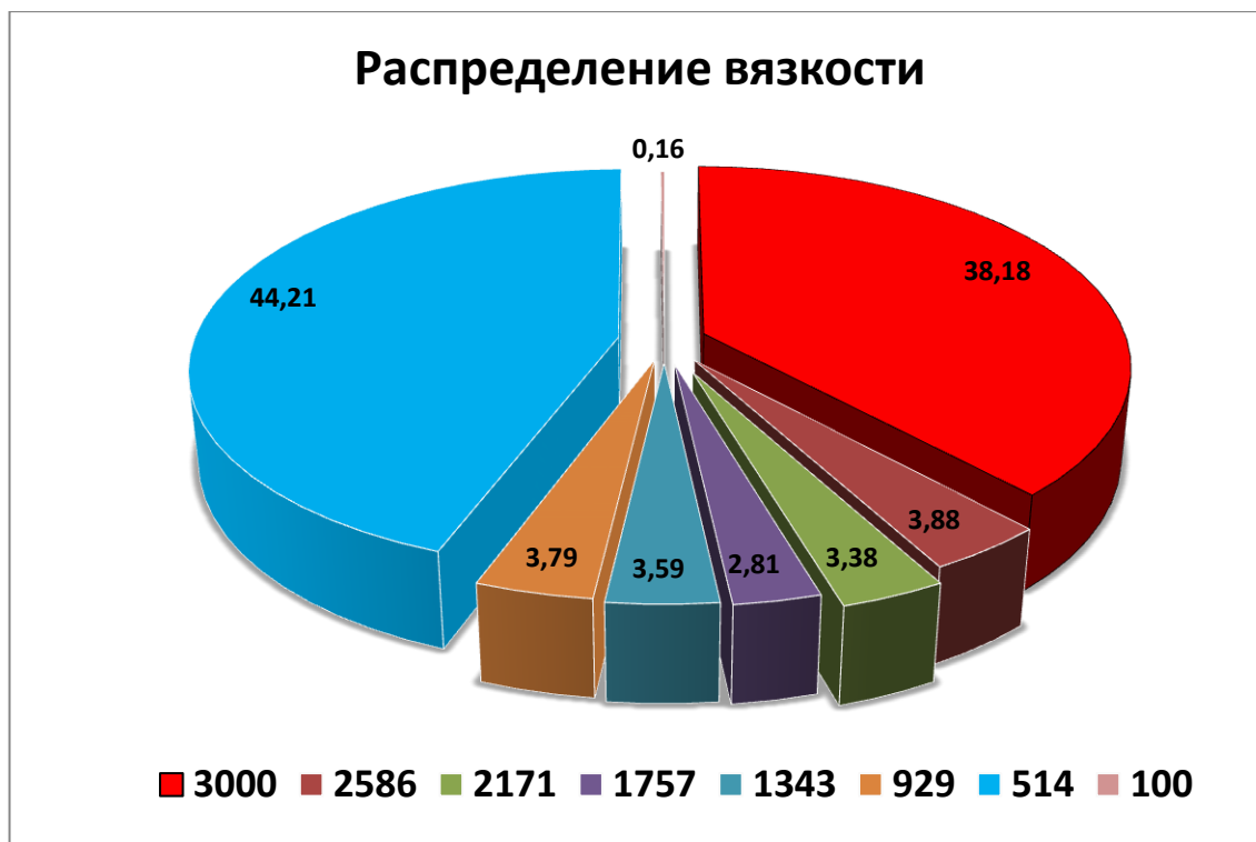
Рисунок 3.18 – Диаграмма распределения вязкости в прямом цилиндрическом канале диаметром 2мм
