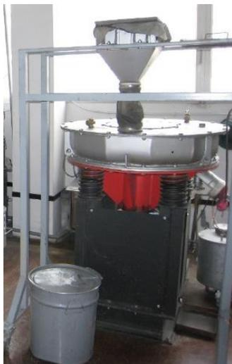
Рисунок 2.12 – Внешний вид вибромельницы
