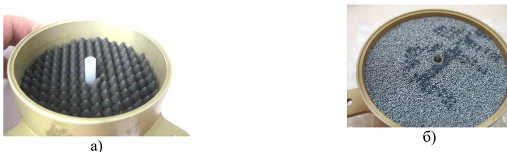
Рисунок 3.69 – Внешний вид вставки из магнитного РПМ РАН-98 (а) и диэлектрического РПМ РАН-46М (б)
