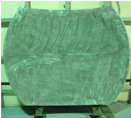
Рисунок 3.16 – Параболический отражатель СШП ЗА в исходном виде с размеченной овальной центральной зоной (в состоянии поставки)
