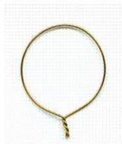
Рисунок 5.46 – Кольцевая проволочная скрутка из нихромового провода
