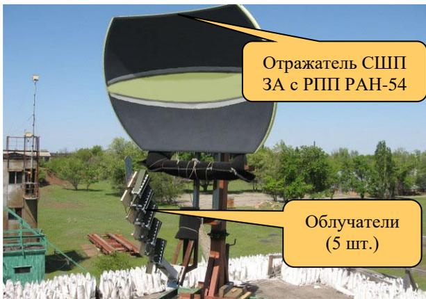
Рисунок 3.24 – Полевые испытания экспериментального образца СШП ЗА с нанесенным РПП РАН-54 на радиополигоне
