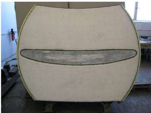
Рисунок 3.20 – Параболический отражатель СШП ЗА после снятия маскировки и подрезки краев РПП РАН-54
