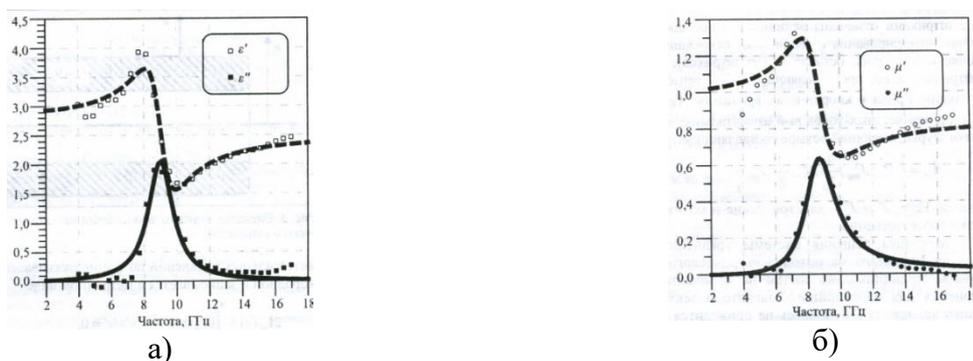
Рисунок 5.108 – Частотные зависимости эффективной диэлектрической (а) и магнитной (б) проницаемости образца ММ LR-2В (точки – экспериментальные значения, линии – аппроксимации функциями лоренцевских резонансов)
