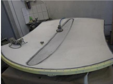
Рисунок 3.21 – Сведение на «ус» толщины РПП РАН-54 в центральной зоне СШП ЗА
