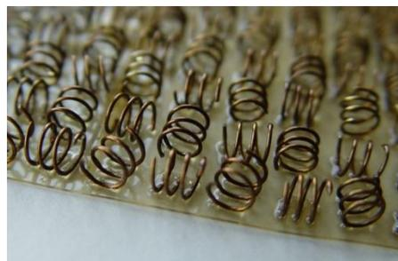
Рисунок 5.72 - Элементарная ячейка (а) и экспериментальный образец (б) ММ LR-5A, изготовленного из лево- и правозакрученных проволочных спиралей
