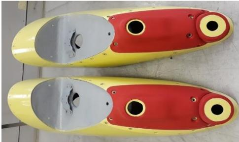
Рисунок 3.44 - Внешний вид законцовок крыла ЛА с нанесенным РПП РАН-67 (красного цвета)
