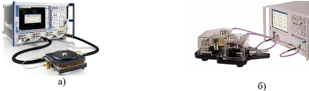
Рисунок 1.1 – Резонаторный метод измерений параметров материалов на базе ВАЦ Rohde & Schwarz (а) [43] и Keysight (б) [35]
