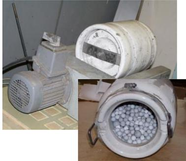
Рисунок 2.9 – Керамическая шаровая мельница для сухого помола порошка КЖ
