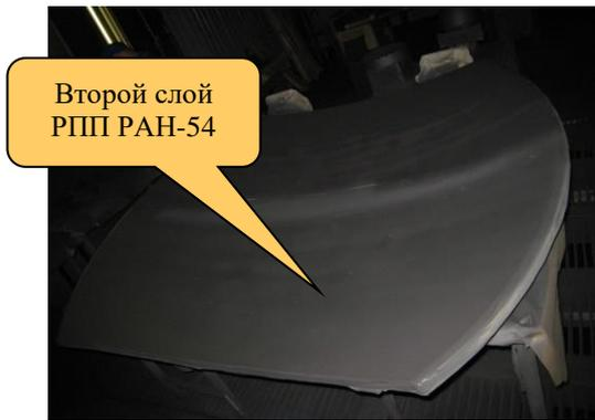
Рисунок 3.18 – Параболический отражатель СШП ЗА после нанесения первого функционального слоя РПП РАН-54 из композиции на основе компаунда С-1М
