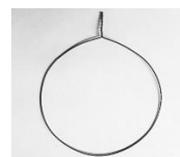
Рисунок 5.54 - Нагруженное разорванное кольцо – резонансное включение ММ
