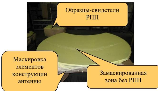
Рисунок 3.17 – Параболический отражатель СШП ЗА после маскировки и нанесения грунтовки с образцами-свидетелями покрытия
