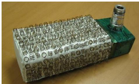
Рисунок 5.124 – Внешний вид волноводной антенны с трубкой из ММ LR-5D
