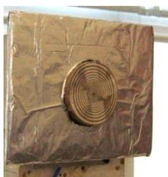
Рисунок 3.72 – Макет спиральной антенны на металлическом экране
