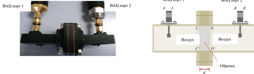
Рисунок 1.8 [46]– Волноводная линия передачи для измерения параметров материалов
