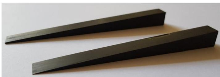
Рисунок 3.86 - Внешний вид двух образцов вставки из РПМ на основе РПМ РАН-89 для волновода WR-159
