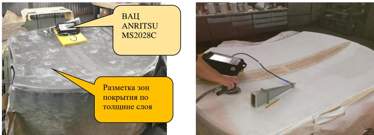
Рисунок 3.19 – Измерение КО РПП РАН-54 на поверхности отражателя с помощью портативного ВАЦ *ANRITSU MS2028C* и рупорной антенны
