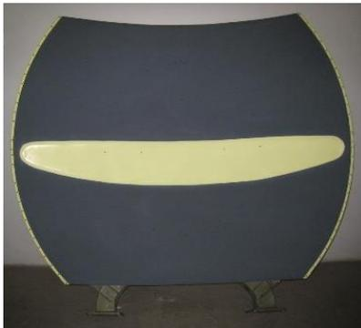
Рисунок 3.22 – Итоговый вид СШП ЗА с РПП РАН-54 после нанесения защитного покрытия (шестого слоя из композиции на основе компаунда С-5)
