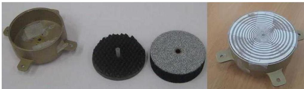
Рисунок 3.68 – Детали конструкции спиральной антенны
