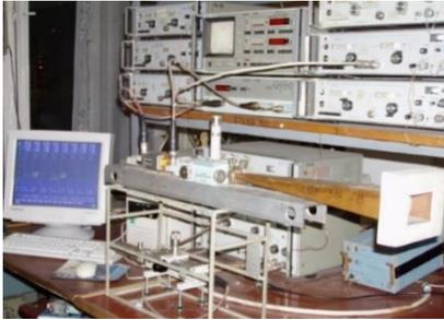
Рисунок 1.13 – Внешний вид разработанного стенда для измерения параметров материалов в ближней зоне рупорных антенн в свободном пространстве
