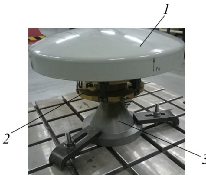
Рисунок 1.21 – Система виброизоляции: 1 – двигатель-маховик; 2 – магнитожидкостный виброизолятор; 3 – испытательный стенд
