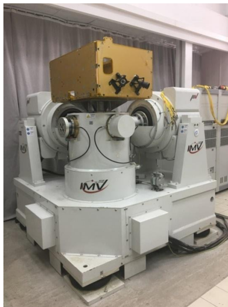
Рисунок 3.35 – Схема вибродинамических испытаний космического аппарата типа «Искра-5» на вибростенде TS-2000-4H
