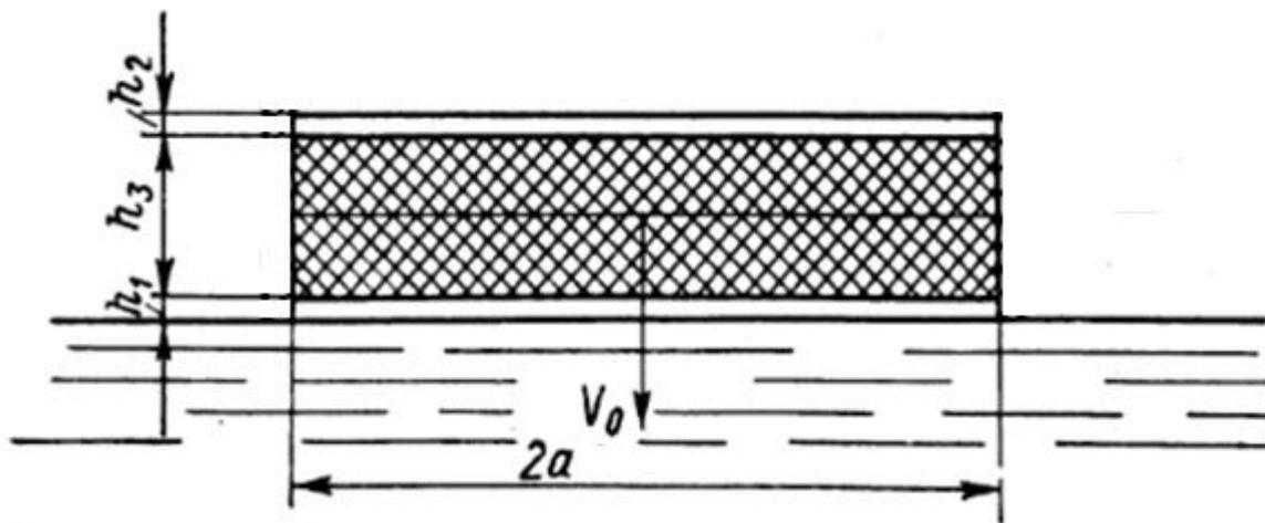
Рис. 2 Модель трехслойной симметричной по толщине пластины в начальный момент взаимодействия с жидкостью
