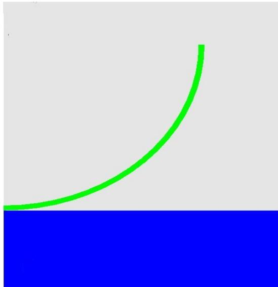
Рис.1 Осесимметричная модель шарового сегмента
