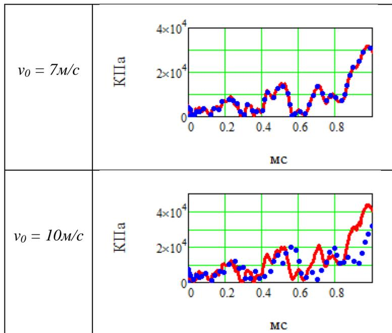
В таблице 9 приведены зависимости влияния начальной скорости погружения на максимальные перемещения, ускорения и напряжения. Видно, что на рассмотренном участке начальных скоростей, перемещения, ускорения и напряжения имеют линейную зависимость.
