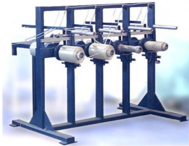
Рис. 8. Компенсаторы, совмещенные со шпуляриками
