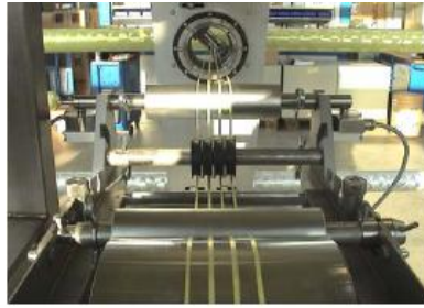
Рис. 7. Типовая схема пропиточного устройства
