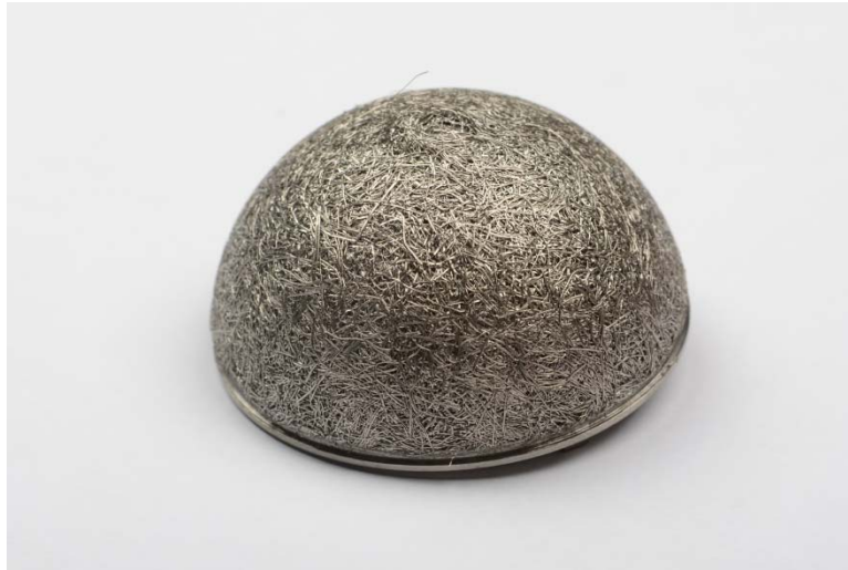
Рисунок 7 - Макет вертлужного компонента эндопротеза тазобедренного сустава из сплава ВТ6 с остеоинтегрирующим покрытием из волокон сплава ВТ1-0
