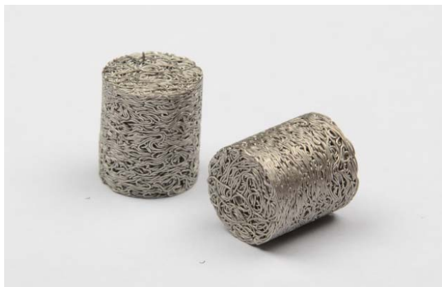
Рисунок 6 - Макеты протезов тел позвонков, изготовленные из волокон технического титана
