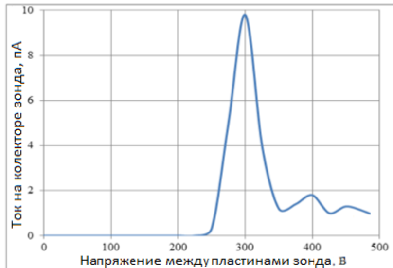
Рисунок 15. Вольт-амперная характеристика E \times B зонда
