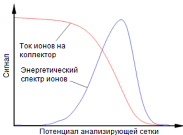
Рисунок 2. Типичный сигнал с коллектора зонда.
