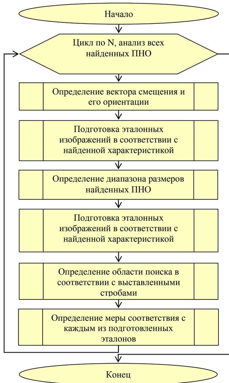
Рис. 9 – Блок-схема модифицированного алгоритма идентификации
