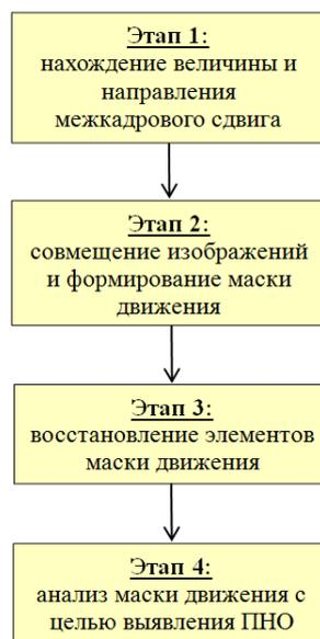
Рис. 1 – Обобщенная структура метода обнаружения ПНО
