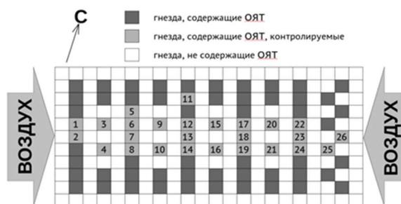
Рис. 9. Схема контролируемых гнезд хранения ОЯТ ВВЭР-1000 в натурном эксперименте [14]
