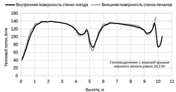
Рис. 7. Распределение теплового потока по высоте гнезда хранения ОЯТ
