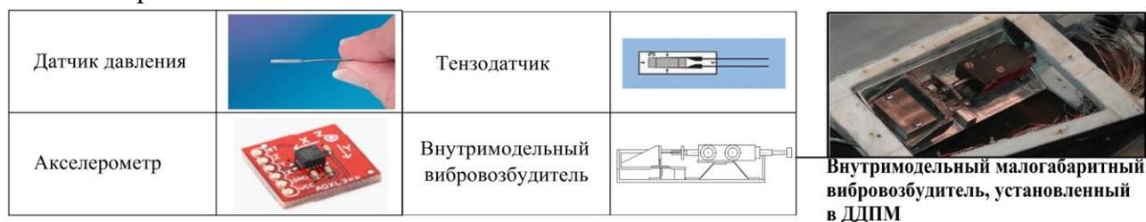
Рисунок 14 – Внутримodelьное оборудование ДДПМ
