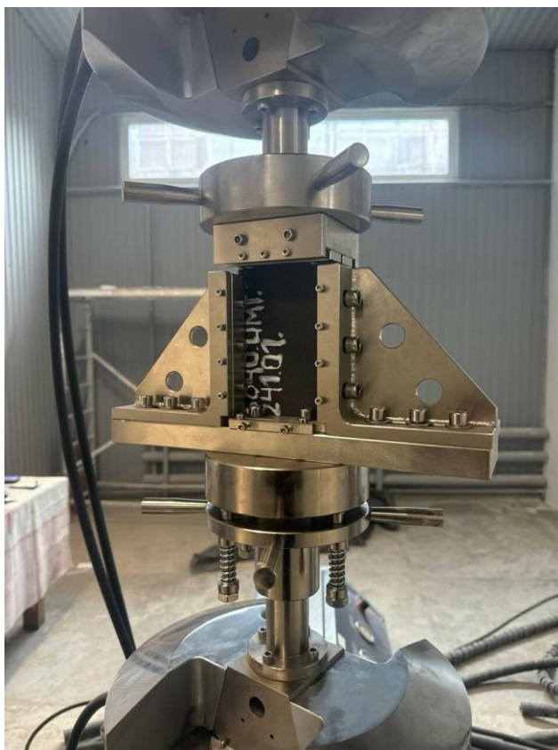
Рисунок 25 - Конфигурация нагружающего приспособления с установленным образцом
