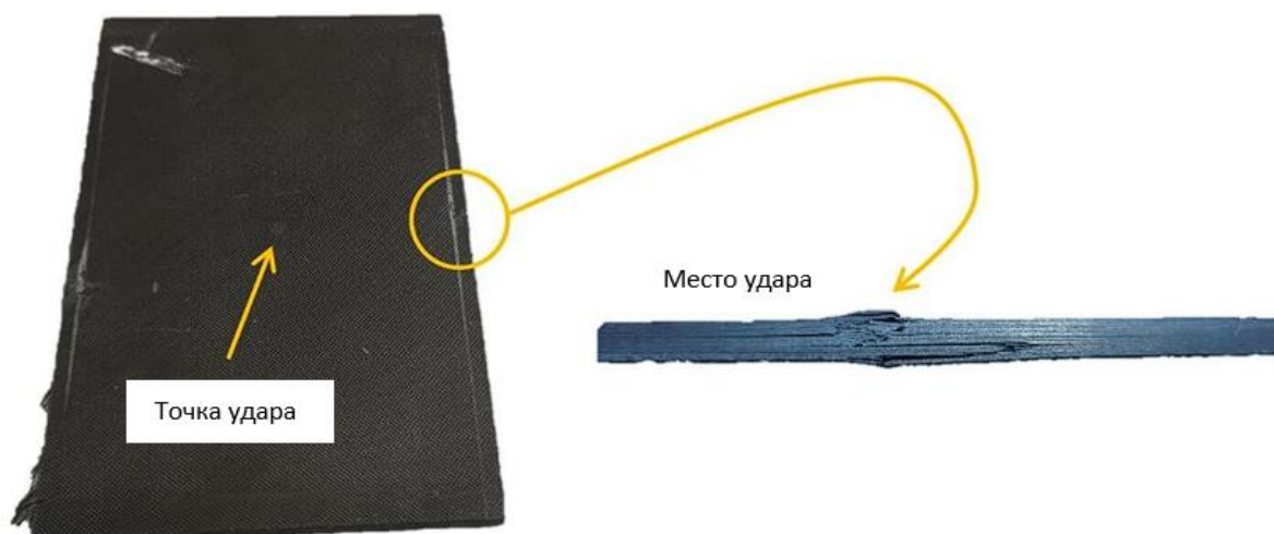
Рисунок 28 - Образец после разрушения в статическом испытании на сжатие после удара
