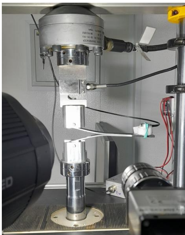
Рисунок 10 - Испытания по ГОСТ 56793 – 2015 образцов ПКМ АСМ102-С130UD
