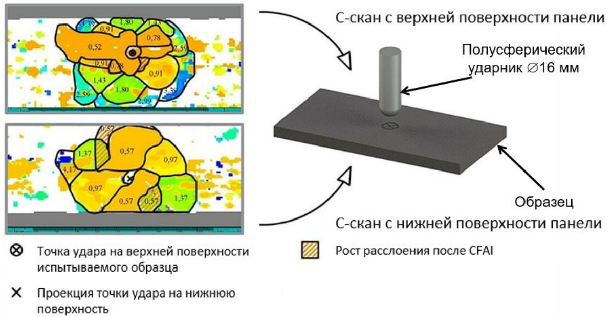
Рисунок 31 - Схема нанесения удара и данные С-сканирования образца 5040.UMT.241.01 после удара и после циклической нагрузки
