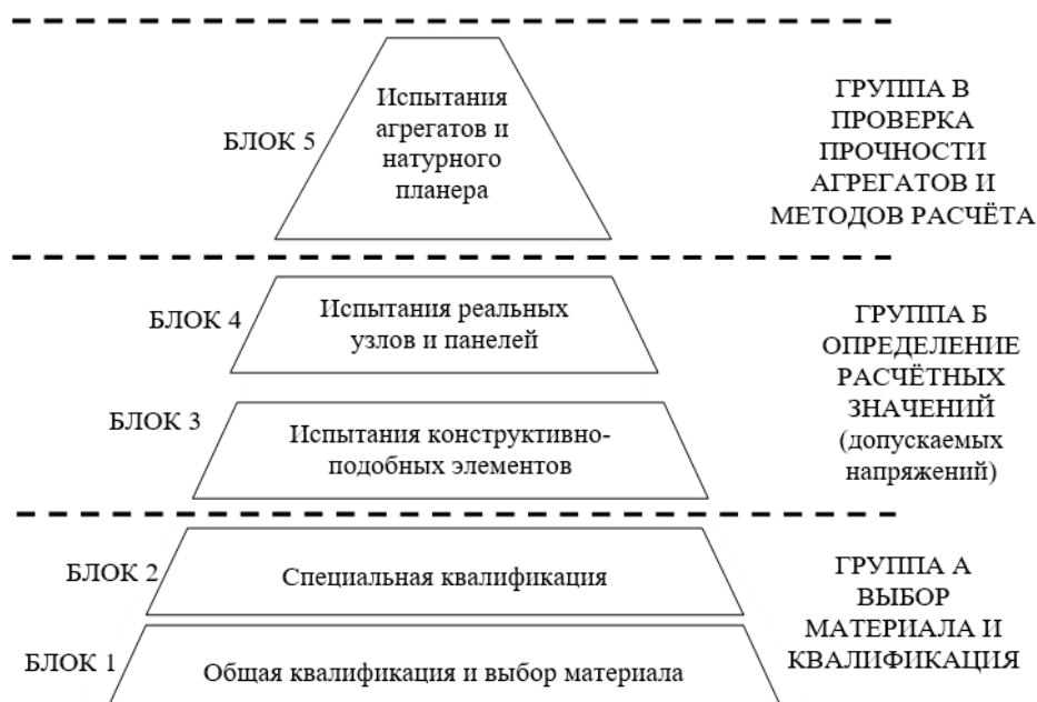
Рисунок 3 - Пирамида расчетно-экспериментальных образцов РЭО [26]
