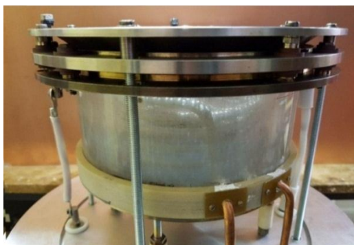
Рисунок 1.34 – Расположение индуктора внутри разрядной камеры ВЧИД [86]
