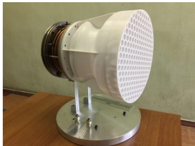
Рисунок 1.21 – Макет прямогочного ЭРД, созданный в рамках выполнения проекта RFMEFI57714X0101 (гексагональное сечение канала УЗАГ). [51]
