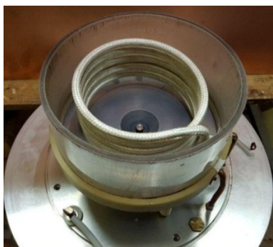
Рисунок 1.34 – Расположение индуктора внутри разрядной камеры ВЧИД [86]
