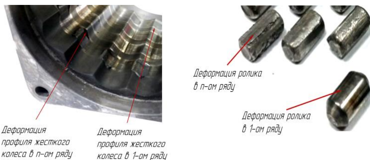
Рисунок 3.1. Жесткое колесо и тела качения ВПТК после ресурсных испытаний
