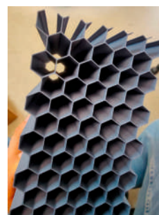
Рис. 8. Тестовый образец секции хонейкомба, изготовленный методом FDM-печати
