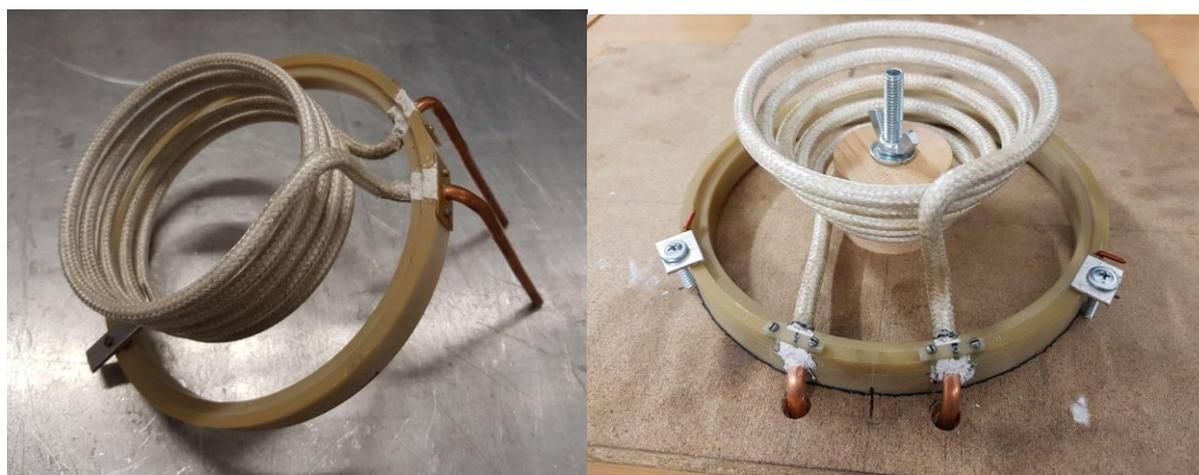
Рисунок 3 – Цилиндрический и конический индукторы с посадочным кольцом. ВЧИД-15-3.
