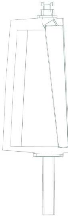
Рис. 5.13. Конструкция лопатки ВНА с единой полостью.
