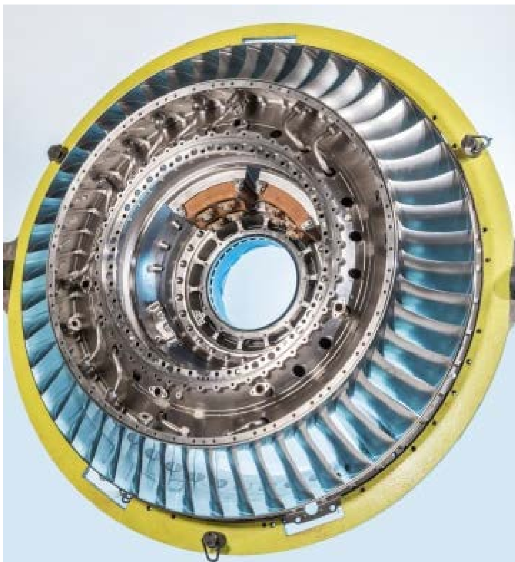
Рис. 1.3. Аддитивный корпус передней опоры двигателя, Rolls-Royce
