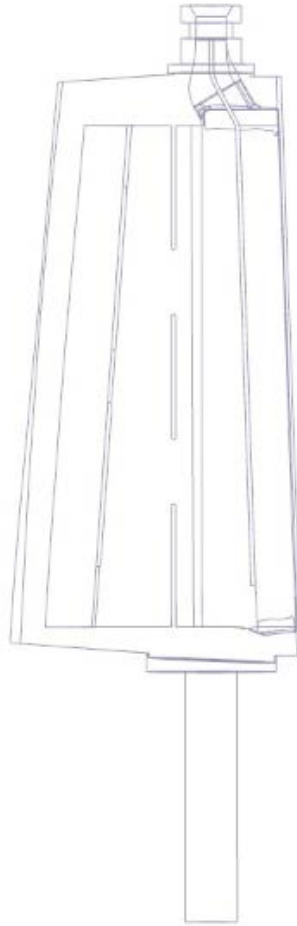
Рис. 5.15. Конструкция лопатки ВНА с не сплошными перегородками.
