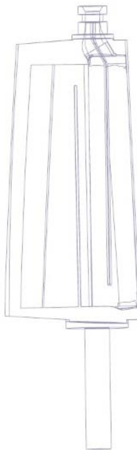
Рис. 5.14. Конструкция лопатки ВНА со сплошными перегородками.
