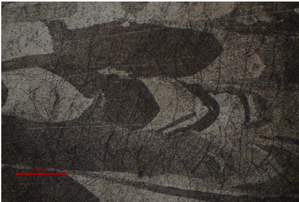
Рисунок 4.3. Поперечное сечение после травления, увеличение x200.
