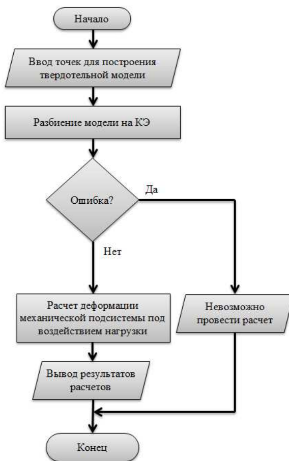
Рисунок 2.11 – Стандартный алгоритм проведения математического моделирования механической подсистемы МОЭМС в программном комплексе ANSYS
