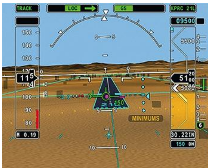
Рисунок 1 – 3D-план ландшафта, сгенерированный ССВ компании Honeywell на пилотажно-навигационном кадре
