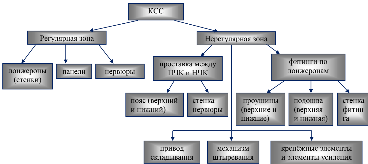
Рис.7. Элементы отсека крыла со стыком складывания
