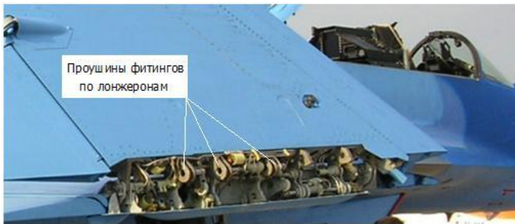
Рис. 5. Вид на лонжеронный стык складывания самолёта МиГ-29К
