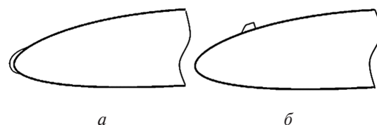
Рис. 1. Профиль крыла с различными типами ВГ: a – серповидной формы на передней кромке крыла; б – трапециевидной формы на верхней поверхности крыла (на 5–10% его хорды)
