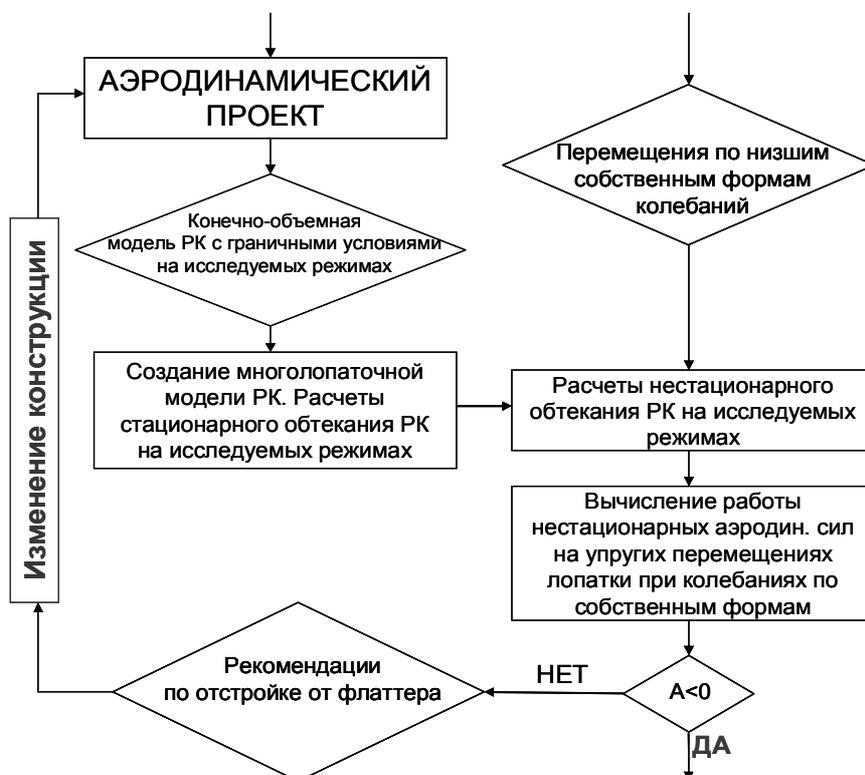
Рис. 8. Фрагмент блок-схемы процесса создания компрессора (рис. 9) в части расчётного прогнозирования флаттера
