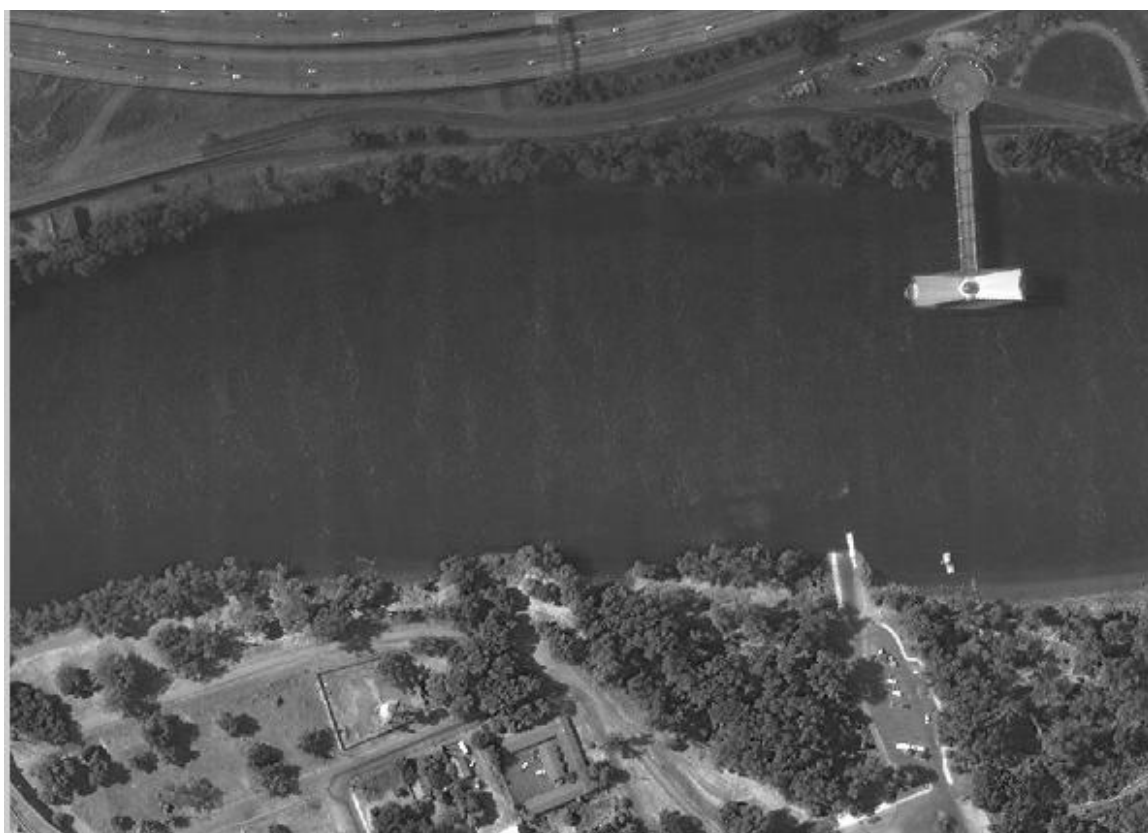
Рис. 88. Результат фильтрации с помощью прямоугольного фильтра и весовых коэффициентов, зависящих от локальных дисперсий входного изображения.
