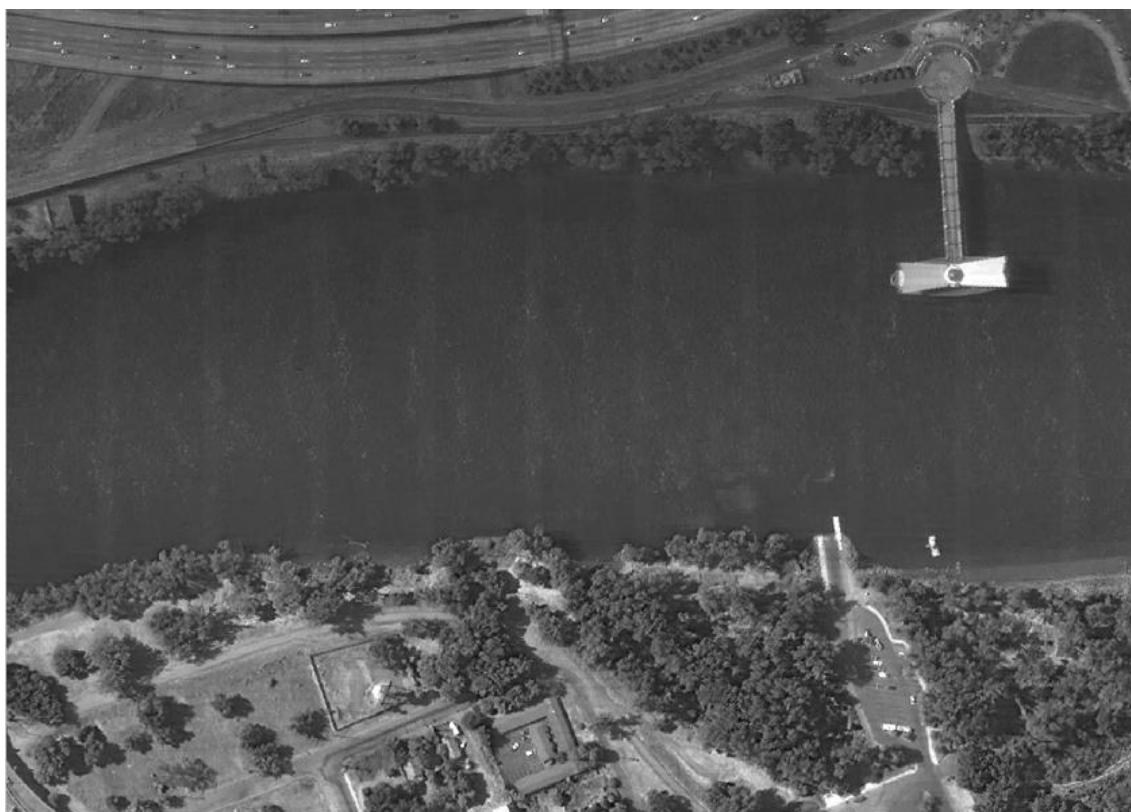
Рис. 92. Результат фильтрации с помощью треугольного фильтра и весовых коэффициентов, минимизирующих локальную дисперсию конечного изображения.
