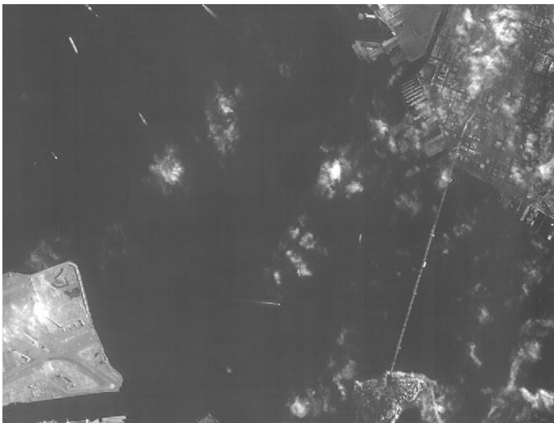
Рис. 83. Результат фильтрации с помощью прямоугольного фильтра и весовых коэффициентов, зависящих от локальных дисперсий входного изображения.
