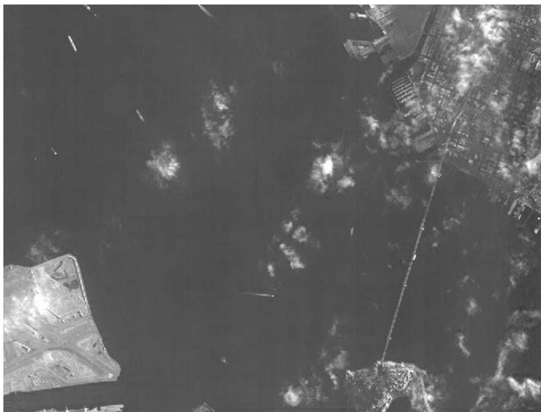
Рис. 84. Результат фильтрации с помощью прямоугольного фильтра и весовых коэффициентов, минимизирующих локальную дисперсию конечного изображения.
