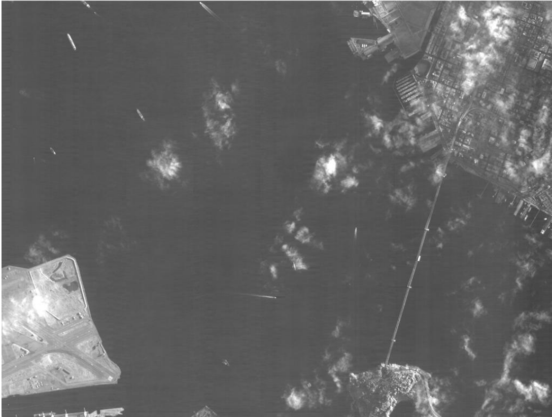
Рис. 85. Результат частотной фильтрации спутникового изображения блочным методом.
