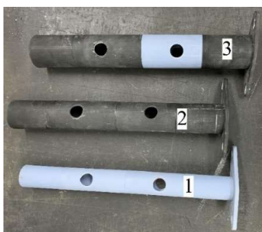
Рис. 3. Фотографии исследуемых ВпКол с разными внутренними диаметрами d : 1 – d = 26 мм; 2 – d = 32 мм (базовая конфигурация); 3 – d = 40 мм
