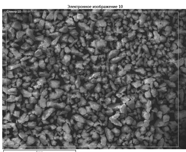
Рисунок 3.12 – СЭМ-изображение порошков 80PSZ/20Al фракцией 40-63 мкм
