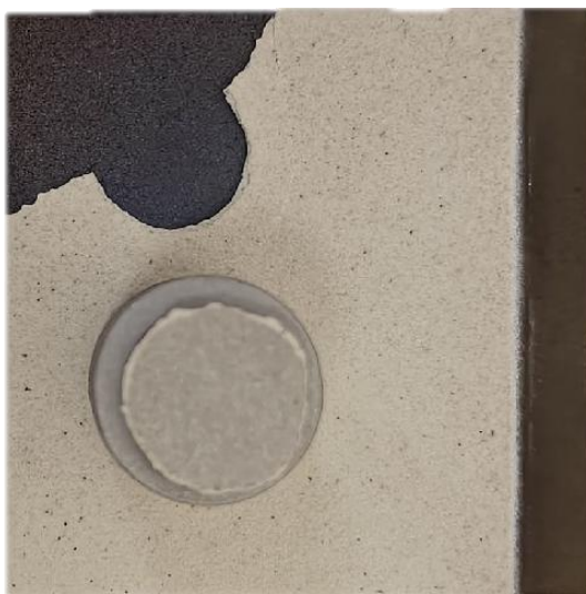
Рисунок 4.10 – Характер разрушения покрытия 18,5\text{Zr}/5\text{Ca}/76,5\text{Al}
