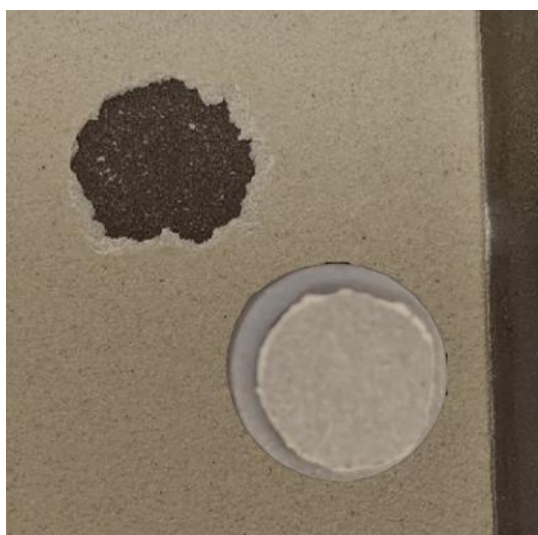
Рисунок 4.11 – Характер разрушения покрытия \text{Yb}_2\text{Si}_2\text{O}_7 на подложке ВТ6
