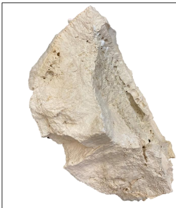
Рисунок 3.17 – Внутренняя структура слитка состава 18,5\text{Zr}/5\text{Ca}/76,5\text{Al} , полученного методом ВЧ переплава
