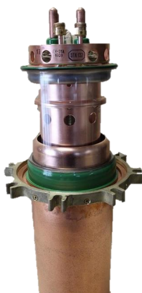
Рисунок 2.4 – Общий вид и схема генераторной лампы ГУ-23А
