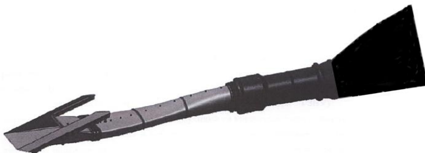
Рис.10 - Общий вид ГПВРД X-51 с изолятором переменного по форме сечения
