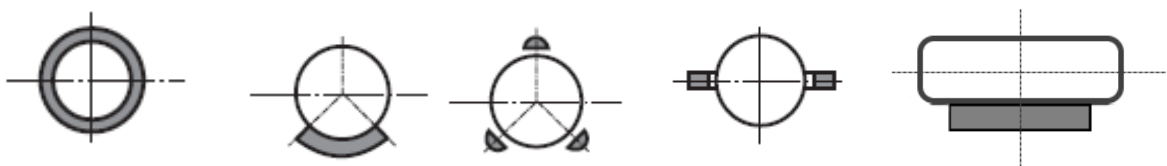
Рис.15 - Схемы ВЗУ и их расположение относительно ЛА
