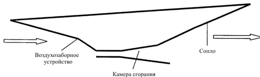
Рис.13 - Схема ЛА с подфюзеляжным типом двигателя
