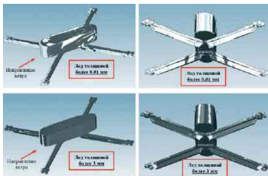
Рис. 10. Результаты обледенения рамы БПЛА для наиболее вероятных условий для образования ГИО
