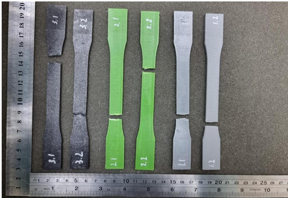
Рисунок 3.38. Образцы на растяжение
