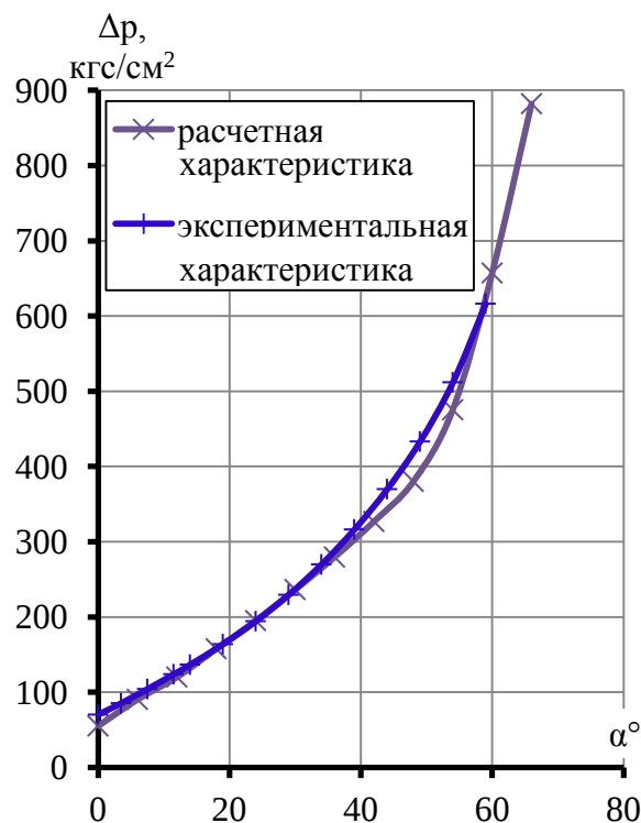
Рисунок 56 – Расчетная и экспериментальная характеристики для профиля окна №3
