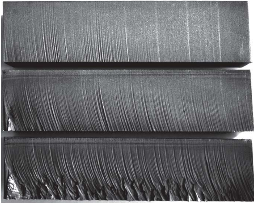
Рис. 4. Поверхность реза образца из закалённой стали 30XГСА толщиной 30 мм при увеличении подачи (справа налево), подача от 5 до 120 мм/мин
