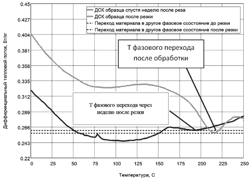
Рис. 14. Термограмма ПКМ до и после гидроабразивной резки
