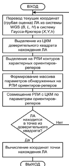
Рисунок 2 – Алгоритм совмещения РЛИ и ЦКМ на основе корреляционно-экстремального метода
