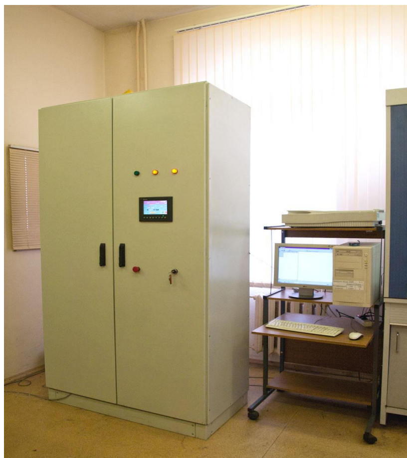
Рисунок 5.14 – Автоматизированный технологический источник тока МДО-100Г для параллельной и индивидуальной обработки деталей методом микродугового оксидирования
