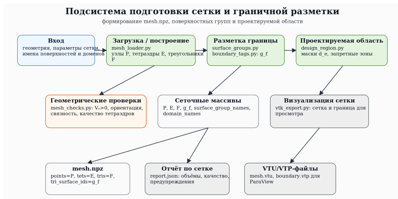
Рис. 3.3. Подсистема подготовки сетки и граничной разметки.
