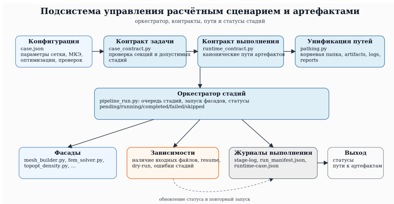
Рис. 3.2. Подсистема управления расчётным сценарием и артефактами.
