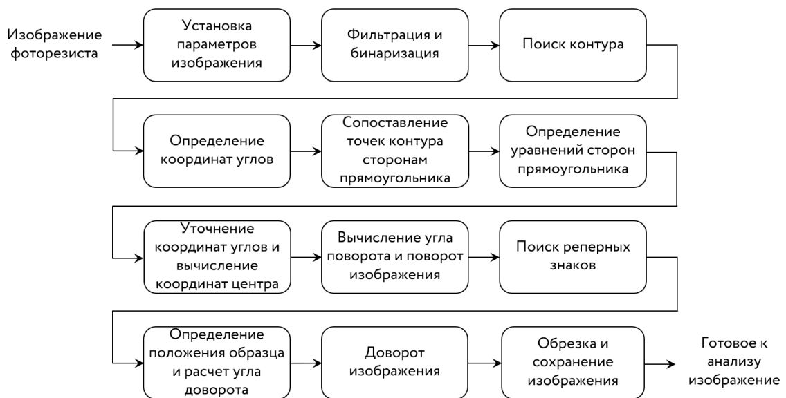
Рисунок 64 — Алгоритм обработки изображений для определения изменения цвета фоторезиста в зависимости от времени экспонирования
