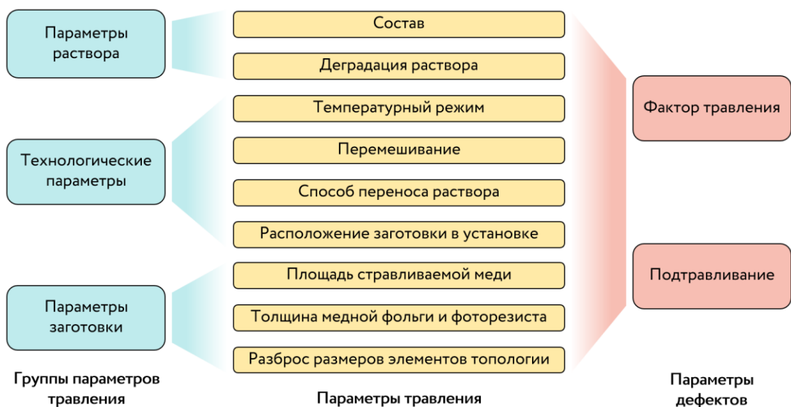
Рисунок 25 — Определение параметров дефектов, возникающих в процессе травления
