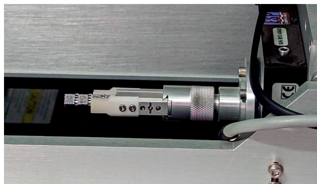
Рис. 2. Пример установки образцов в зажим томографа Nordson DAGE N500 XD7600NT Ruby
